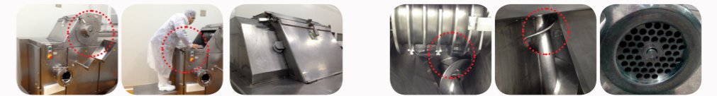
육류를 절단 및 분쇄하는 믹서기 믹서기 연동장치 믹서기 내부 및 재해 발생 지정 등
